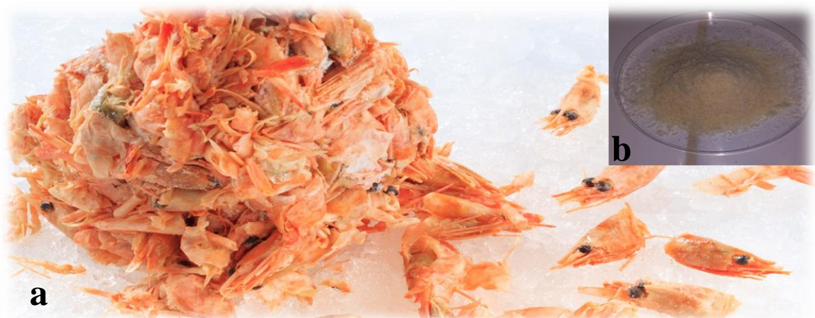
Figure 17 : Chitosane extrait des exosquelettes de crevettes recueilli localement (a) : Exosquelettes de crevettes ; (b) : chitosane.
