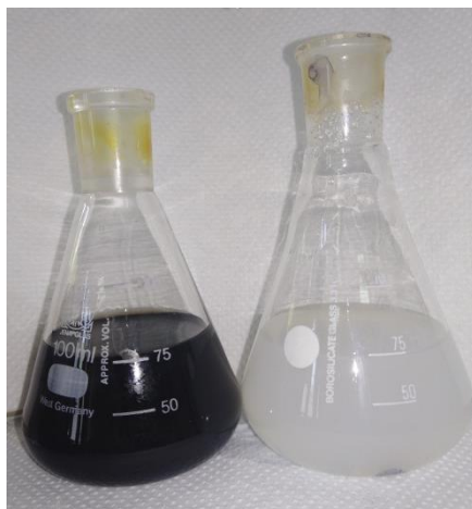
Figure 36 : Décoloration complète après le Titrage de l'iode libéré avec la solution de thiosulfate de sodium 0.01N en présence d'empois d'amidon comme indicateur coloré.
