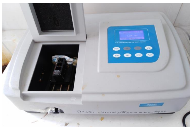
Figure 33 : Spectrophotomètre utilisé pour l'analyse de l'extinction spécifique à 232 nm et 270 nm (Spectrophotomètre UV/VIS 9 200 avec possibilité de lecture pour chaque unité nanométrique)
