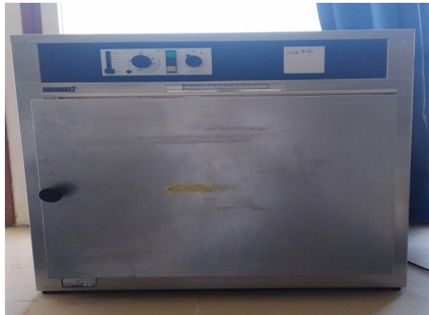
Figure 27 : Etuve utilisée pour le chauffage des échantillons réglé à la température de 103\pm 2^{\circ}\text{C} .
