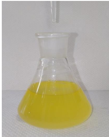
Figure 37: Apparition de la coloration jaune après le titrage avec la solution de thiosulfate de sodium.
