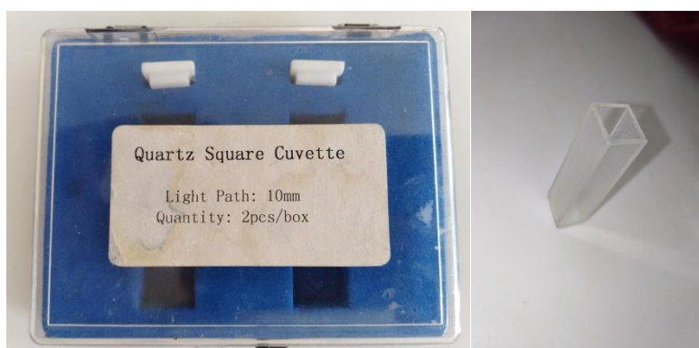
Figure 32: Cuve utilisé durant notre analyse (Cuve en quartz de 1cm d'épaisseur).
