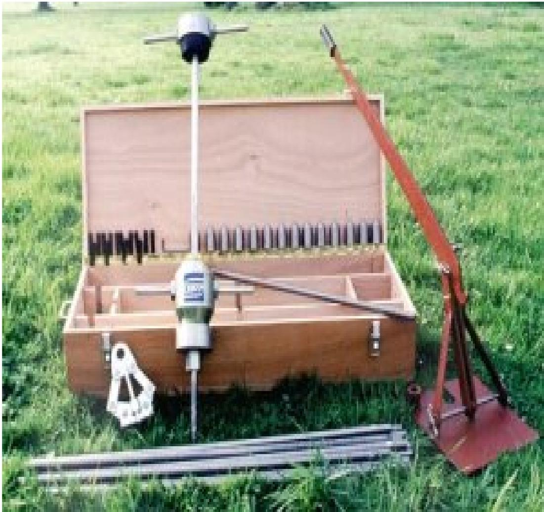
**Fig V.1. L'ensemble pénétromètre**
