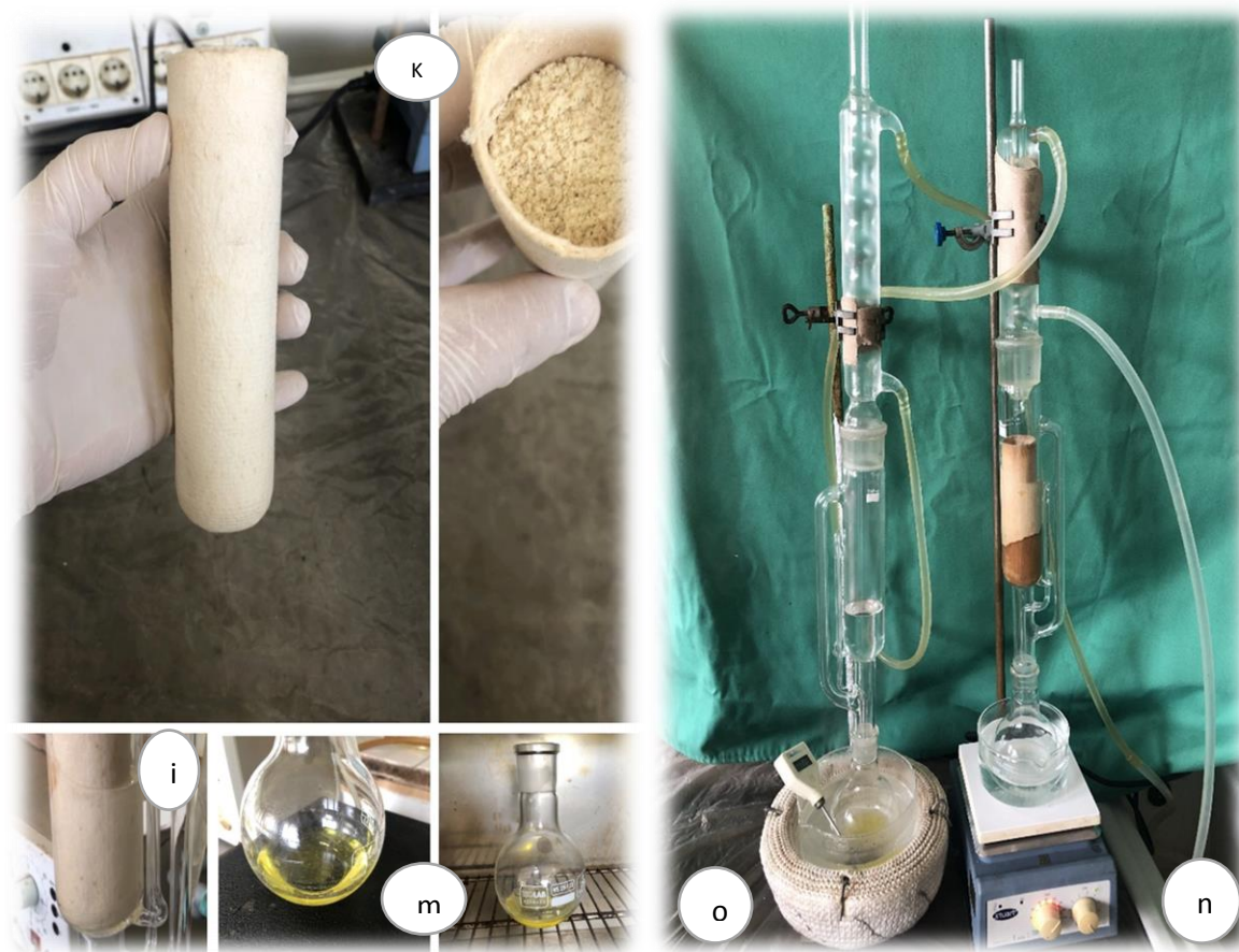
Figure 20 cartouche cellulosique (k) ; cavité (i) ; huile dans le ballon (m).
