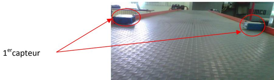
**Figure 2.6 : capteur infrarouge ( ACEL, 9405)**
