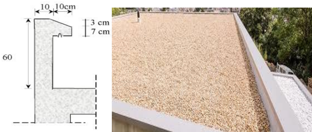
Figure III.6.1: schéma descriptifs de l'acrotère.
