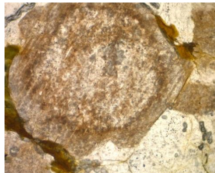
Fig.14b : Vue microscopique des plagioclases altérées au centre fortement souillées par les oxydes de fer LPNA GR 10*0.25 ( IS18BC001)
