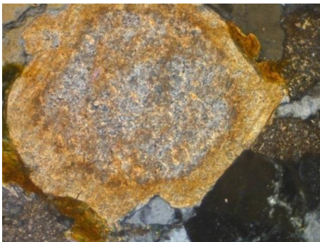
Fig. 14a : Vue microscopique des plagioclases altérées au centre fortement souillées par les oxydes de fer LPA GR 10*0.25 ( IS18BC001)
