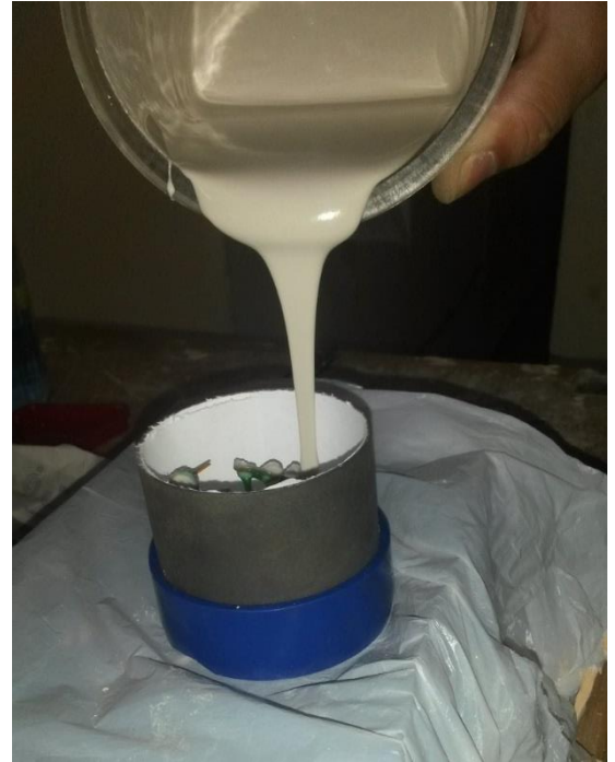
Fig 133 Mise en cylindre de la chape et coulée du revêtement compensateur
