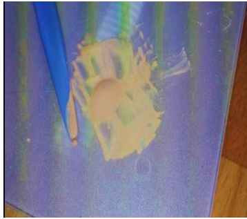
Fig 137 Consistance du Wash Opaquer et son application avec un pinceau plat
