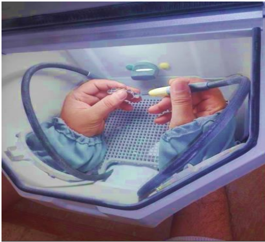
Fig 135 Sablage de la chape métallique et résultat final
