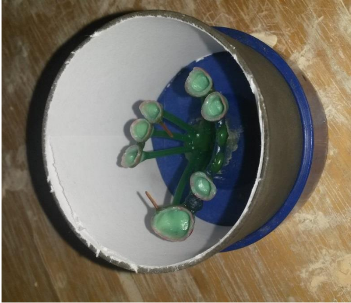
Fig 133 Mise en cylindre de la chape et coulée du revêtement compensateur
