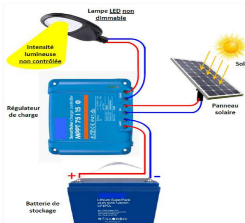
Figure 2.3 Montage complet d'un système d'éclairage solaire sans contrôle de l'intensité lumineuse émise par la lampe LED. [2]
