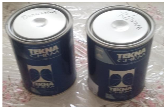
Fig.III.12 : Résine époxydique d'imprégnation pour tissu de renforcement
