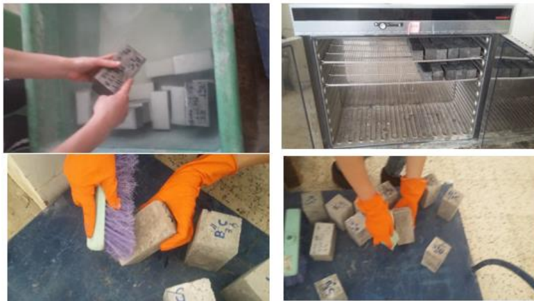
Fig.III.13 : Séchage et nettoyage de la surface latérale des éprouvettes prismatiques en béton
