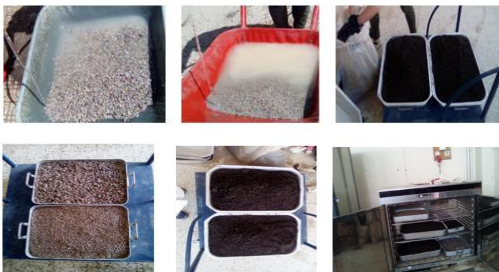
Fig.III.2 : Lavage et séchage des granulats utilisés dans les différentes formulations du béton
