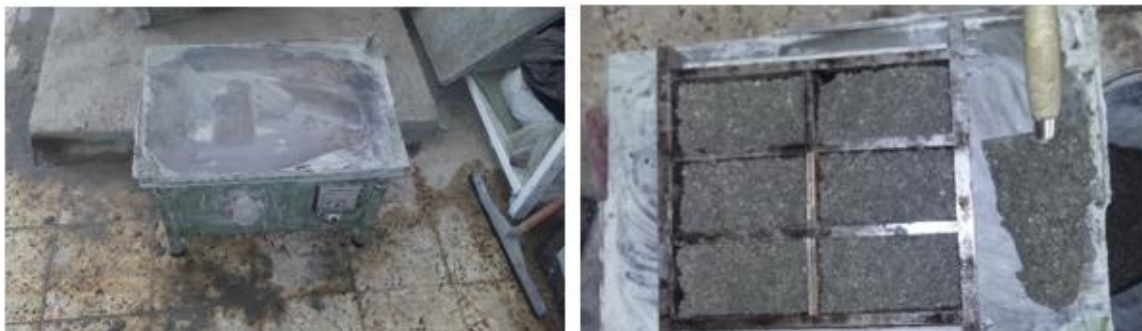
Fig.III.6: Éprouvettes compactées avec une table vibrante (Laboratoire de GC de l'Université de Mouloud Mammeri)
