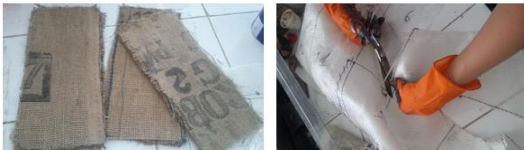
Fig.III.14 : Mesure et Découpage du tissu en fibres de verre et en fibre de jute
