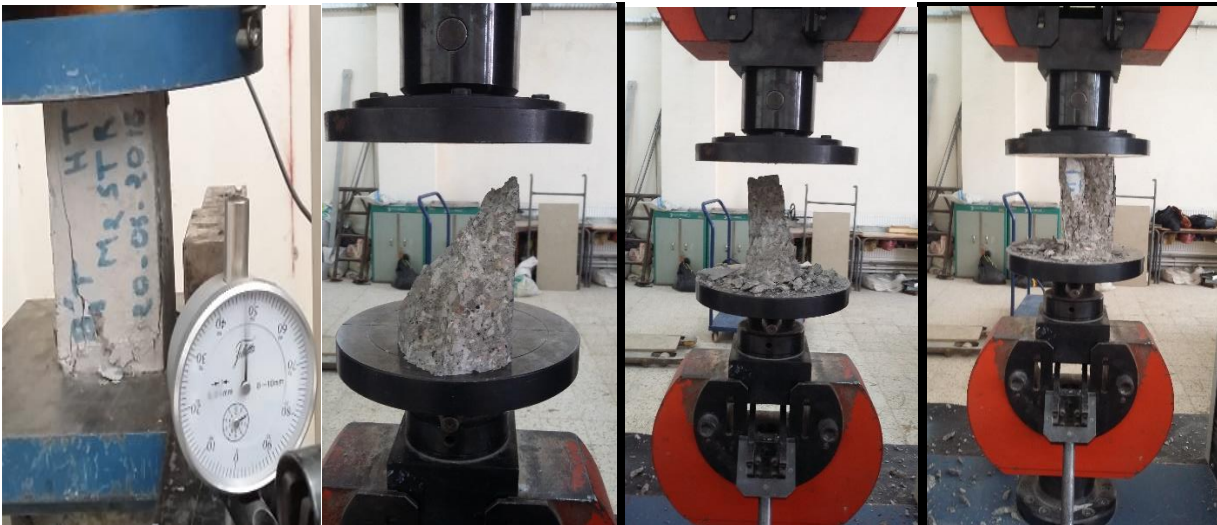
Fig.III.27 : Mode de rupture du béton non confiné
