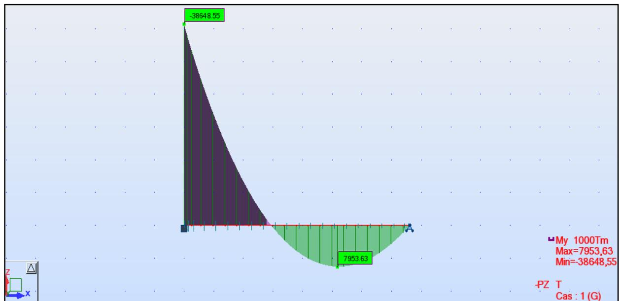
**Fig. VI.53. Diagramme des moments dus au poids propre après clavage de la travée de rive**
