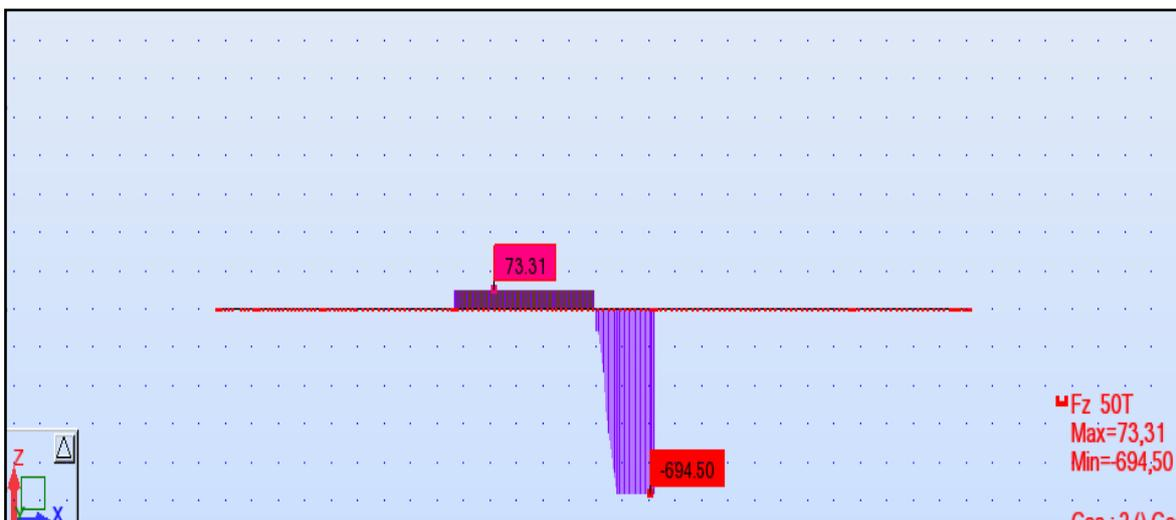
Fig.VI.65. Diagrammes des efforts tranchants sous A (I)
