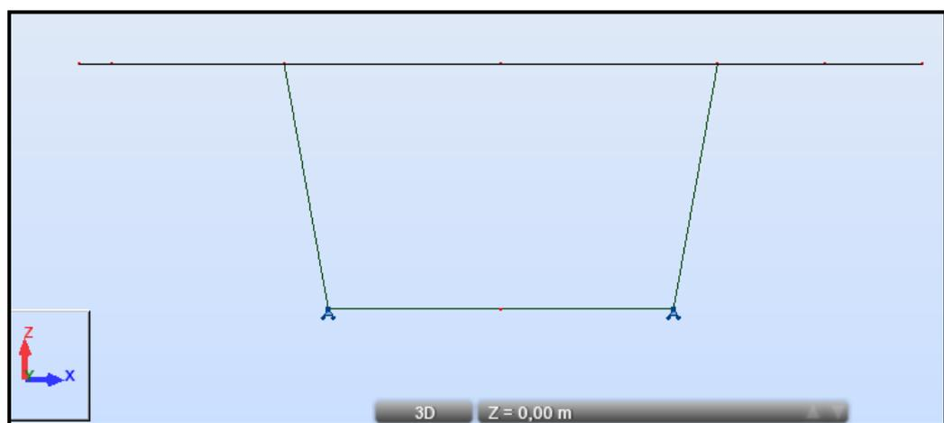
Fig. VIII.4. Schéma statique de calcul (voussoir à la clé)
