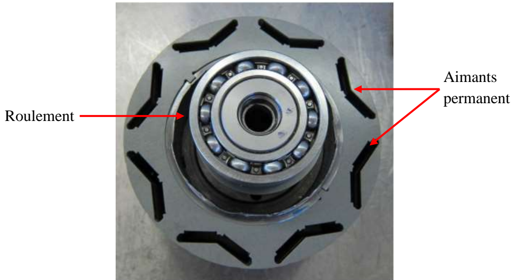
Figure I.10 Structure à aimants enterrés [7]
