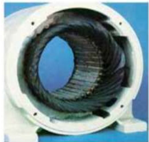
(d) Damage dû à la surcharge
