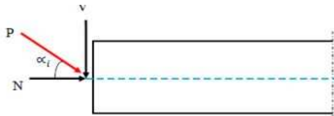
Figure VII.4: composantes de la force de précontrainte
