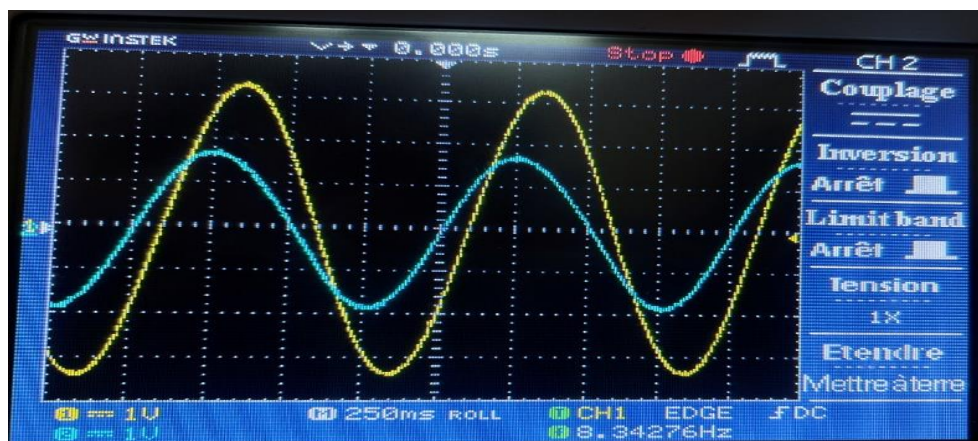
Figure IV.14 : passe bas 4 eme ordre a 5 Hz
