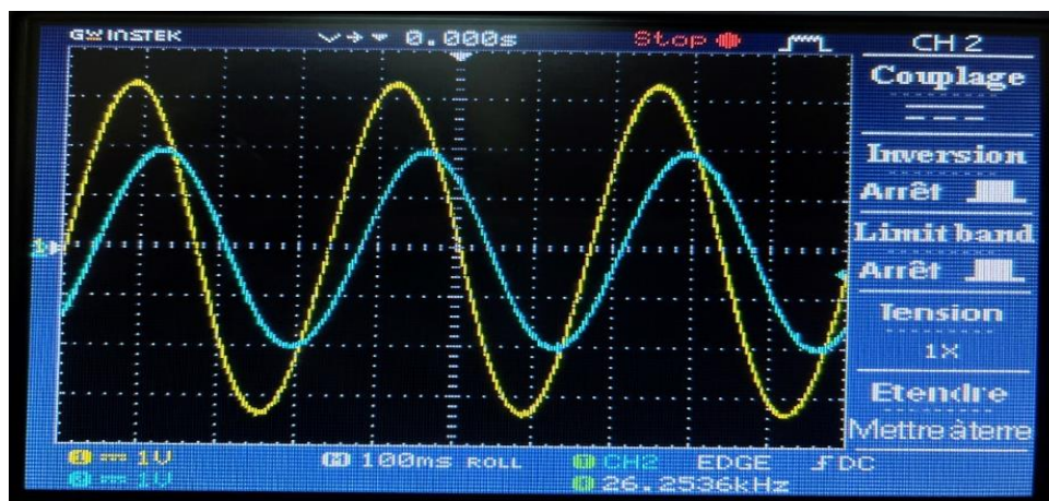
Figure IV.29 : passe bande ordre 4 à 3 hz
