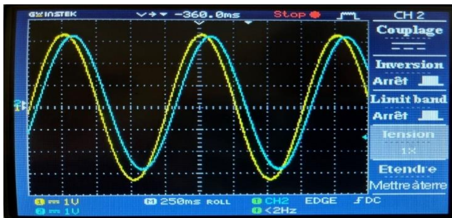
Figure IV.7 : passe bas 2eme ordre à 1Hz
