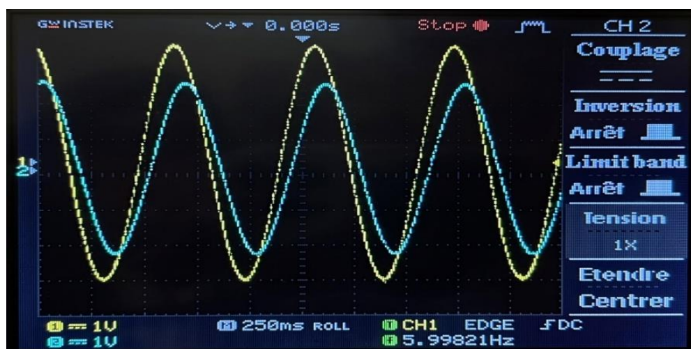
Figure IV.32 : passe bande ordre 6 à 1 hz
