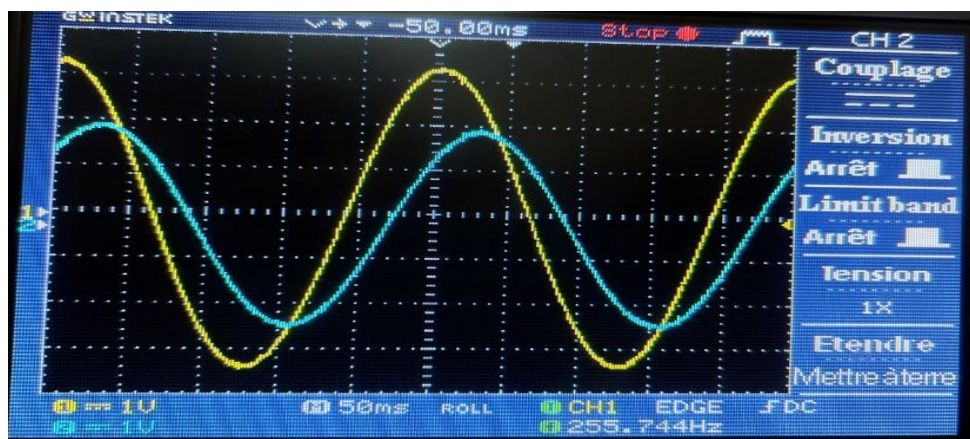
Figure IV.13 : passe bas 4 eme ordre a 1 Hz
