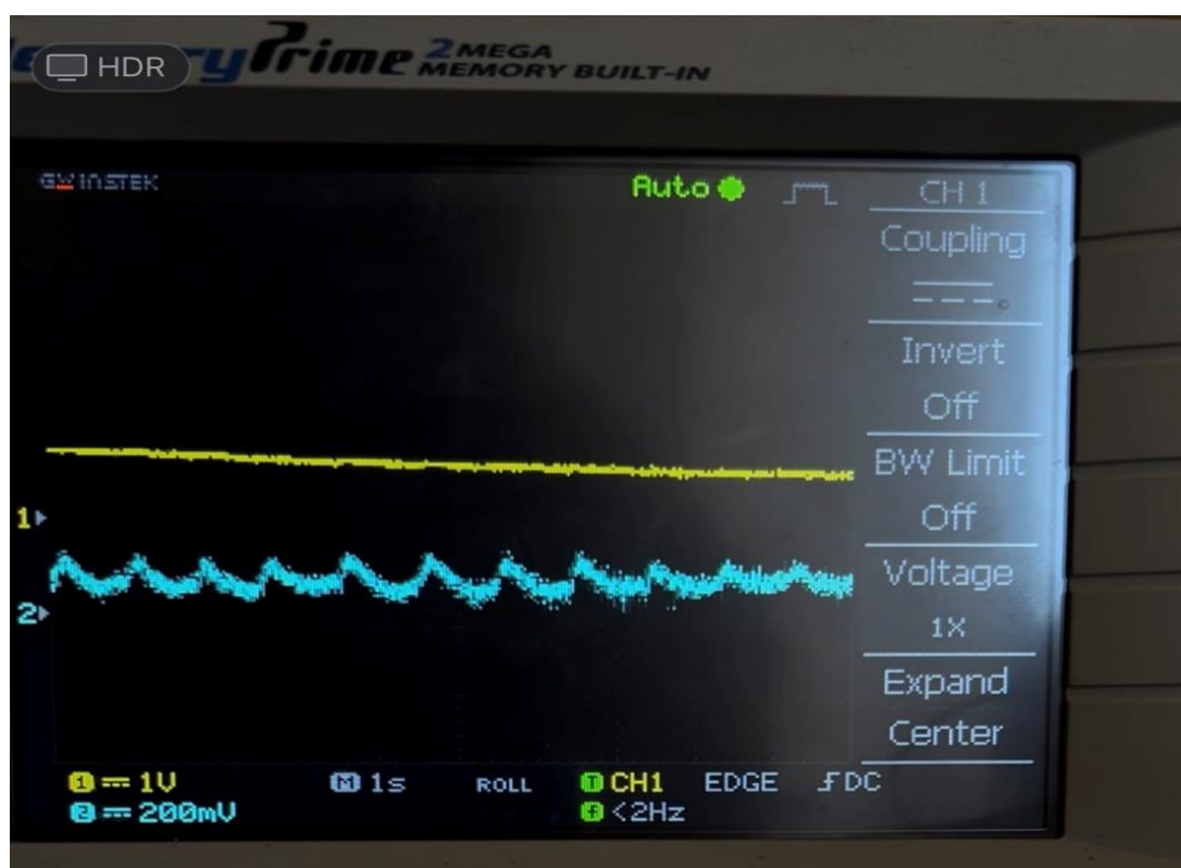
Figure IV.37 : Signaux bruts amplifiés filtrés par Le passe-bande d'ordres 4
