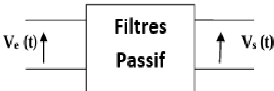
Figure II.8 : Circuit d'un quadripôle
