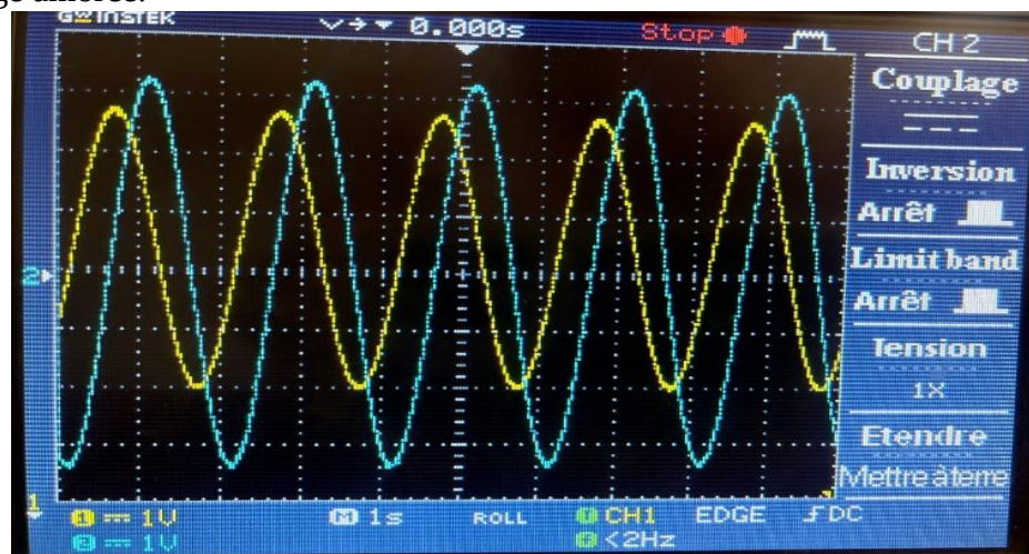
Figure IV.23 : passe haut 6 eme ordre a 0,5Hz
