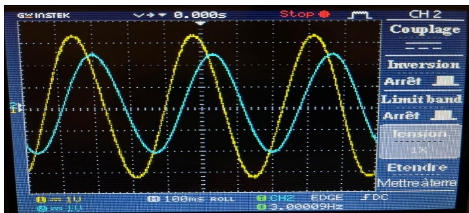
Figure IV.8 : passe bas 2 eme ordre a 3 Hz
