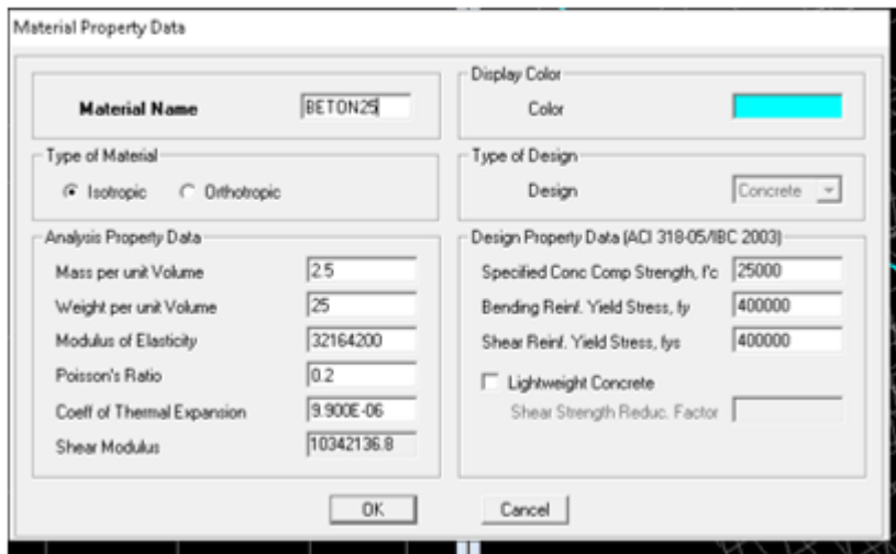
Figure IV-12. : Introduction des propriétés mécaniques du béton.
