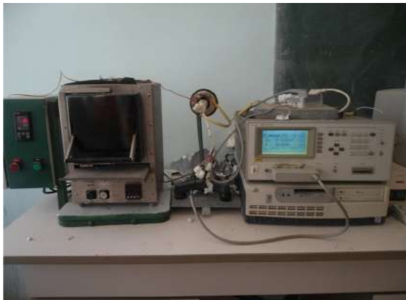
Figure II.5 : Photo de l'appareil de mesures des propriétés diélectriques.
