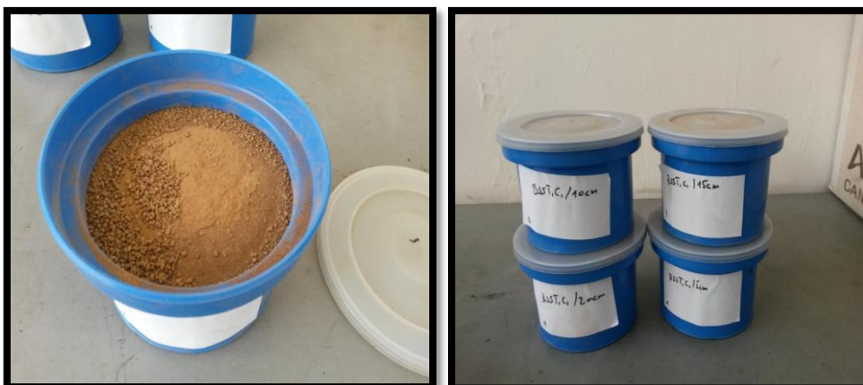
Figure 29 : Conditionnement des échantillons dans des portes échantillons de type Marinelli (Khireche, 2015).
