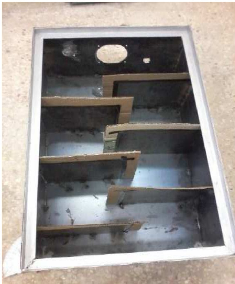
Figure IV.2 : L'enveloppe de l'échangeur.
