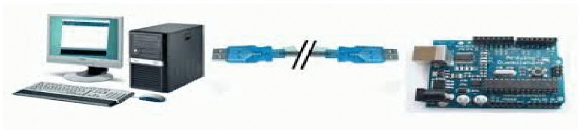
**Figure (II-4) : Alimentation de l'Arduino par un microordinateur**
