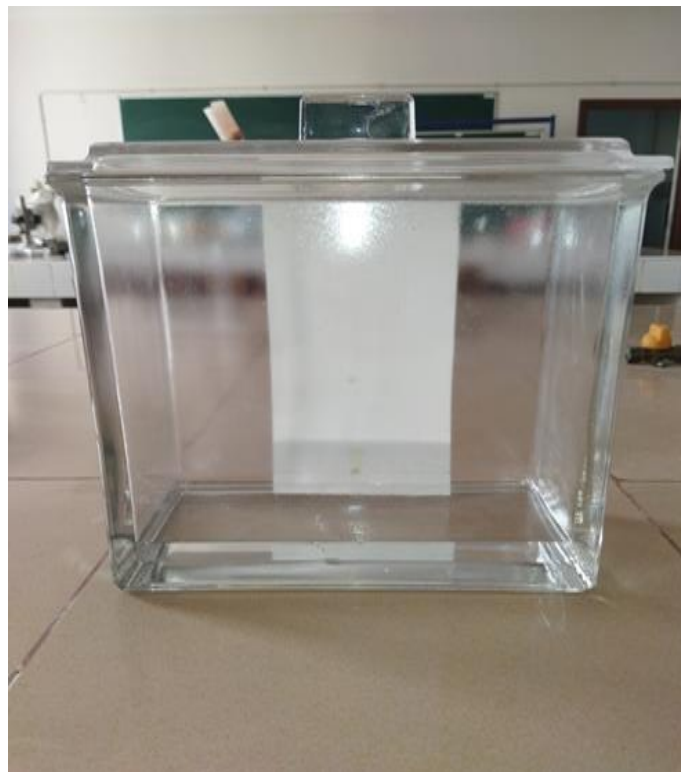
Figure22 : Chromatographie sur couche mince réalisé avec l'hexane, acétate et acide formique (Photo prise au niveau de laboratoire biologie physiologie végétale).
