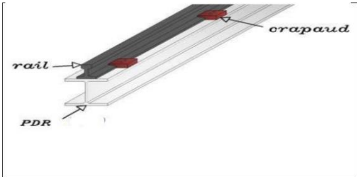
Figure V.12 : Schémas (poutre de roulement + rail).
