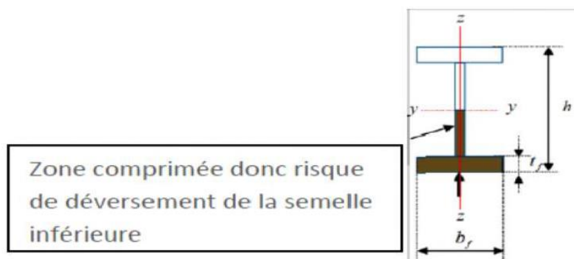
Figure III.7 : Représentation de phénomène de déversement dans la semelle inférieure.
