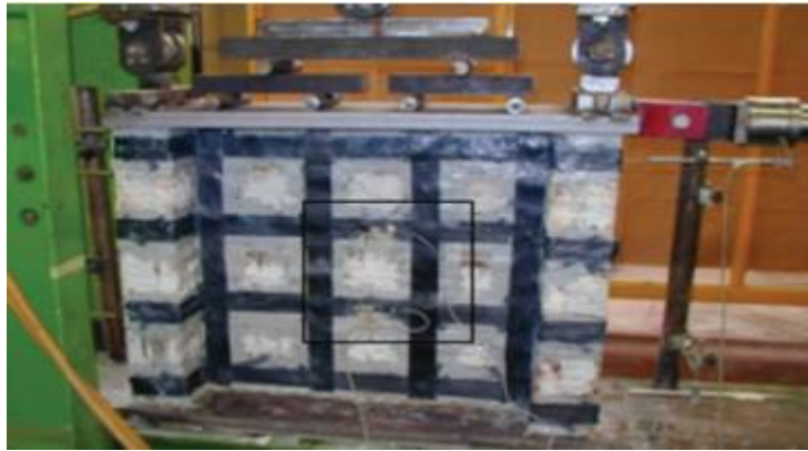
Figure III-7 : Renforcement avec bandes de CFRP. [25]
