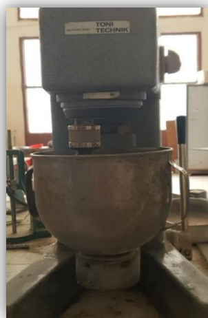
Figure IV-14 : Malaxeur électrique utilisé dans la fabrication du mortier.
