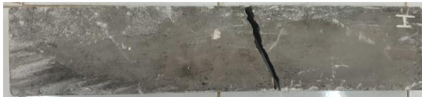
Figure V-25 : Mode de rupture de l'éprouvette témoin (SD)
