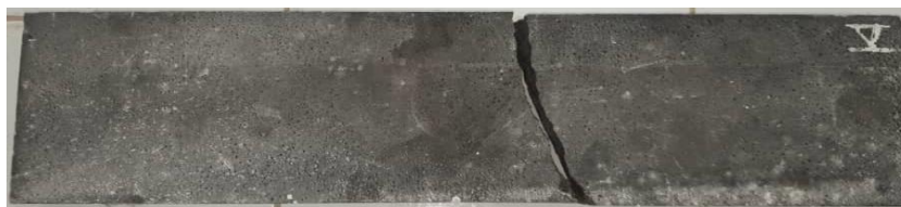
Figure V-26 : Mode de rupture de l'éprouvette témoin (SR)
