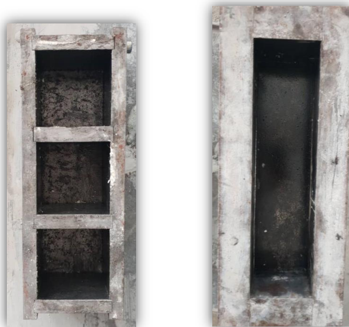
a) Moule cubique (5 \times 5 \times 5)\text{ cm}^3 b) Moule prismatique (2 \times 10 \times 40)\text{ cm}^3
