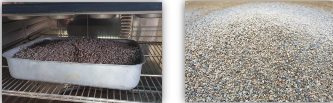
Figure IV-2: Sable de rivière tamisé après avoir été lavé et séché à l'étuve.
