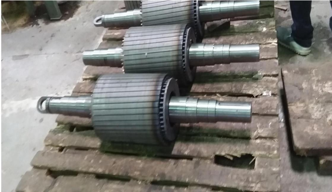
**Figure 17: Rotor d'un moteur électrique**
