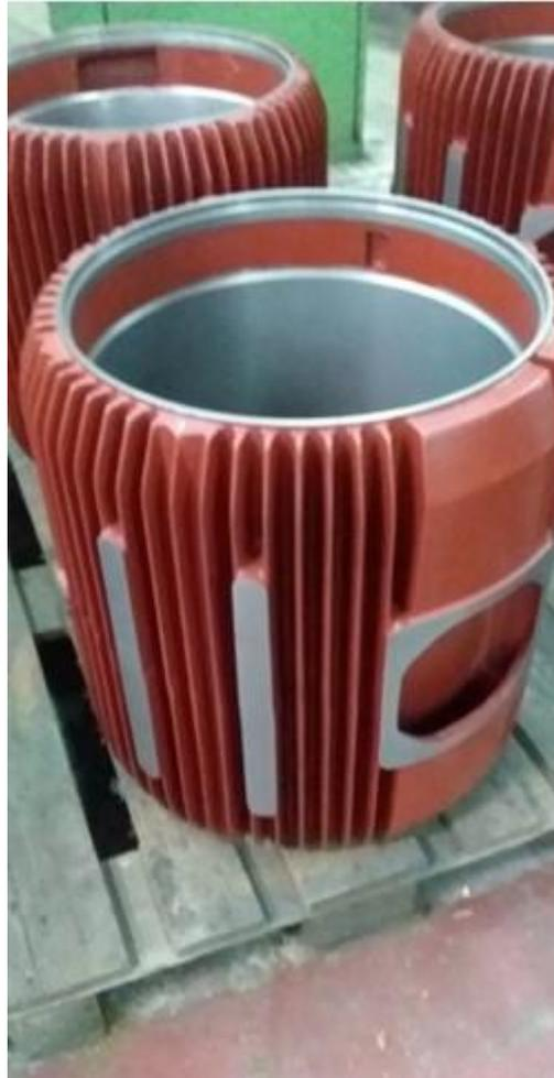
**Figure 14: Carcasse d'un moteur électrique**
