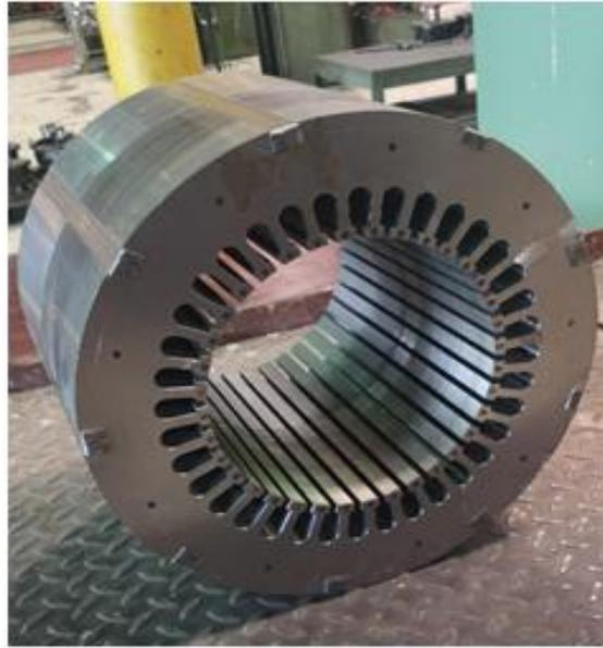
**Figure 16: Stator d'un moteur électrique**
