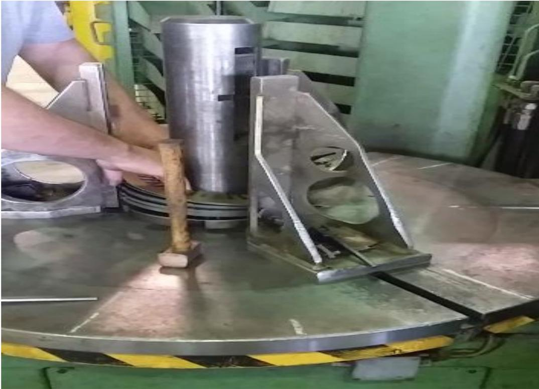
**Figure 6 :** Empaquetage des tôles rotoriques
