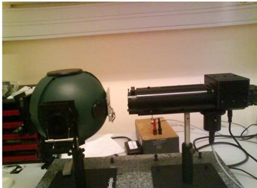
Figure II-16 : Spectromètre muni d'une sphère intégratrice[2].
