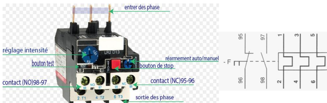
Figure II.14: relais thermique et son symbole
