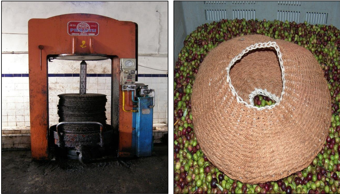
Figure 19 : Presse hydraulique moderne avec des Scourtins traditionnel en fibres de Coco ( Tradition et Modernité (huiledoliveextravierge.com) ).
