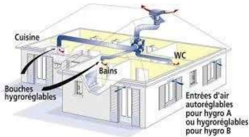
Fig. (I.12) : ventilation mécanique contrôlée par hygroréglables[32].
