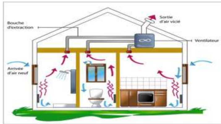
Fig. (I.11) : Ventilation à simple flux[32].
