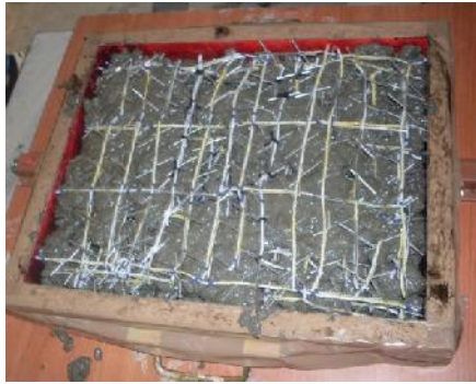
Figure II.14 Réalisation du béton de fibres métalliques orientées.
