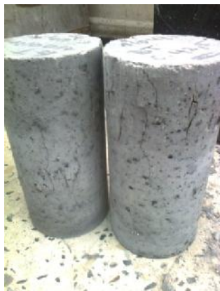
Figure II.20 : Eclatement du béton témoin
