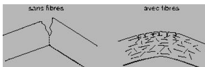
Figure 5.1 : Fissuration dans le béton sans et avec fibres
