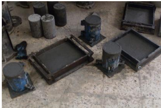
Figure II.13 Réalisation du béton témoin.
