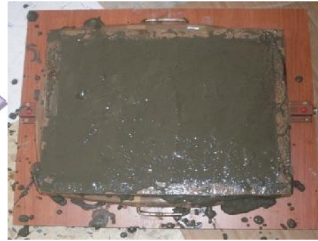
Figure II.14 Réalisation du béton de fibres métalliques orientées.
