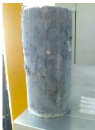
Figure II.21 : Eclatement du béton fibrés
