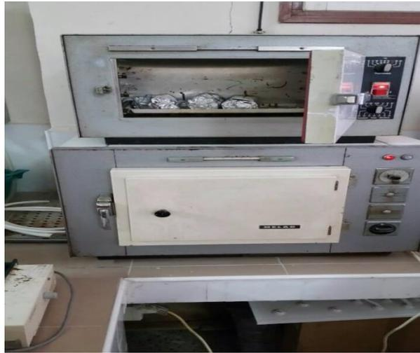
Fig. 2La stérilisation du matériel au four pasteur
