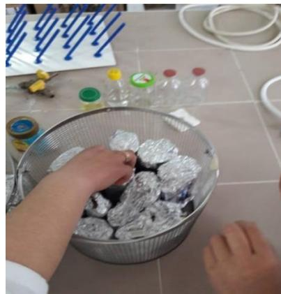
Fig. 11 : Stérilisation des tubes dans l'autoclave (photo originale 2018).
