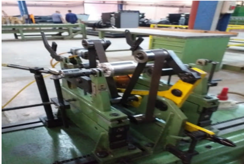
Figure 38 : Equilibrage d'un arbre
