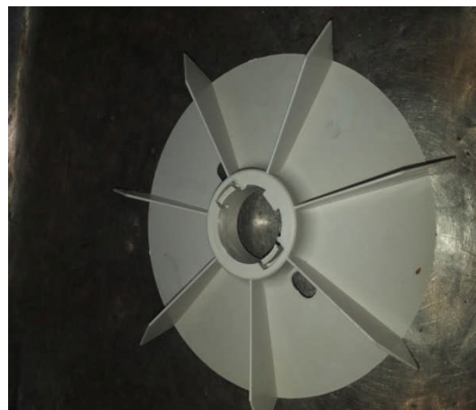
Figure 26 : Ventilateur en plastique
