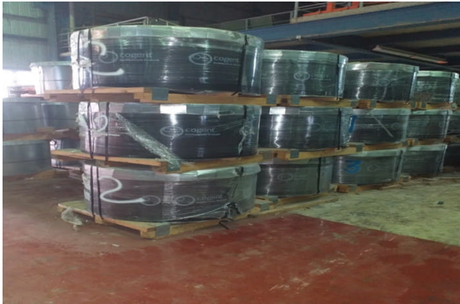
Figure 29 : Bobine de tôle magnétique M800-50A
