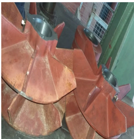
Figure 25 : Ventilateur en fonte
