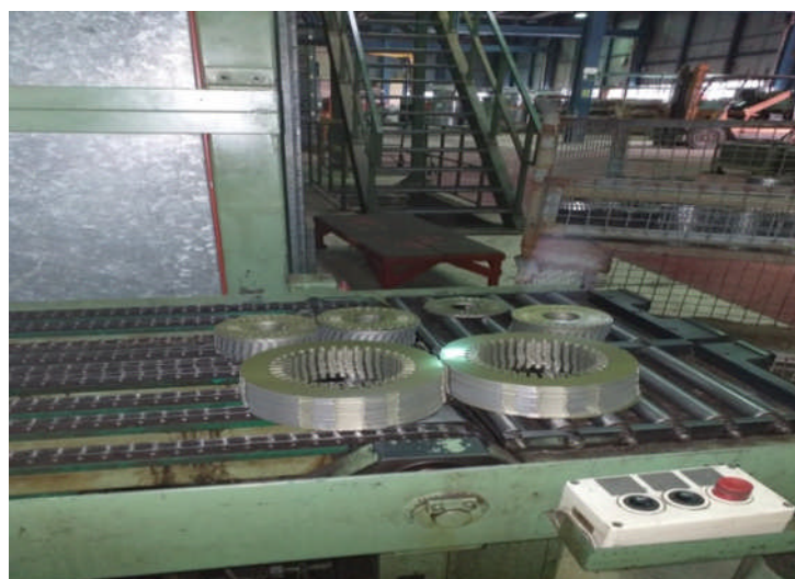
Figure 30 : Des feuilles rotorique et statorique
