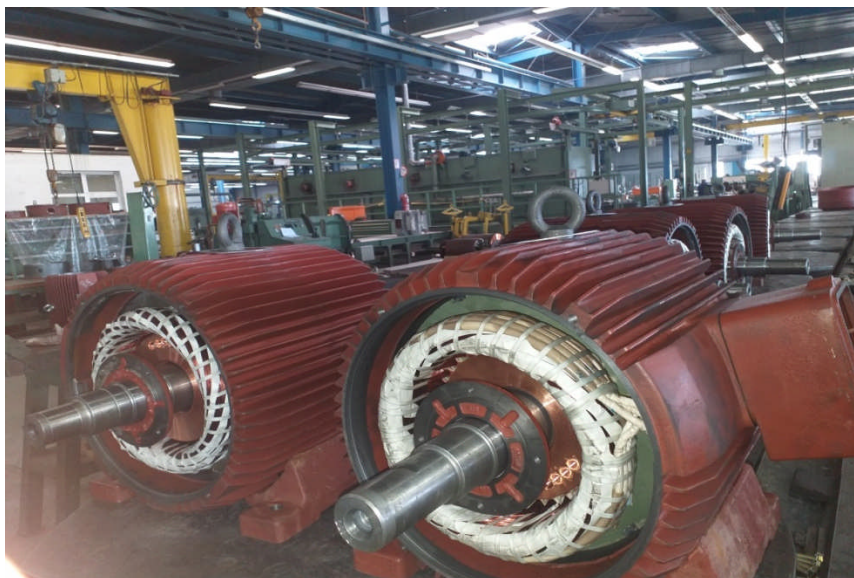
Figure 39 : Montage des moteurs
