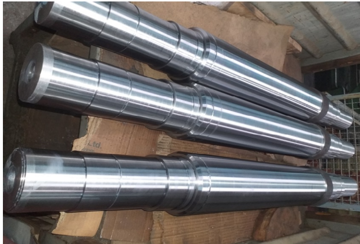
Figure 34: Arbres d'un moteur électrique après usinage
