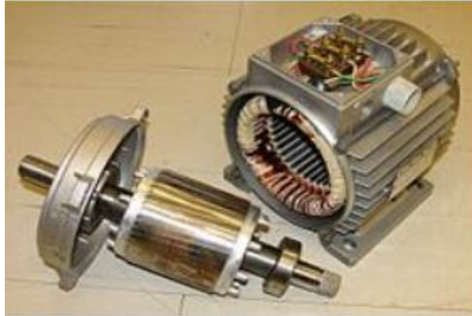
Figure I-4 : les deux parties essentielles de la MAS (rotor à gauche, stator à droite)
