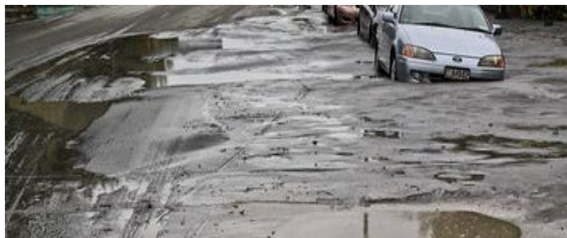
Figure 1.13. Liquéfaction du sol.
