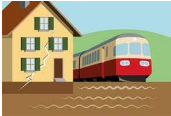
Figure 1.7. Fissures des structures sous l'effet du tassement causé par les sollicitations dynamiques.
