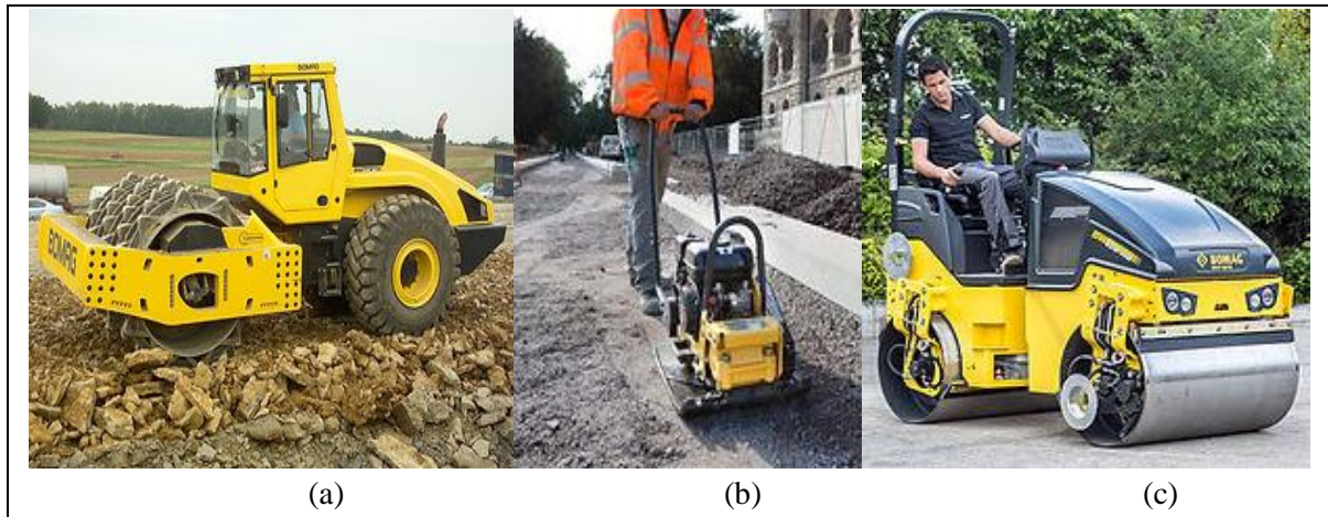
Figure 2.13. Matériel utilisé pour le compactage superficiel : a) Rouleau compacteur à impact, b) Plaque vibrante, c) Rouleau à jante lisse.
