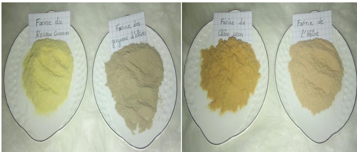
Figure 14 : Les échantillons après Broyage et Tamisage
