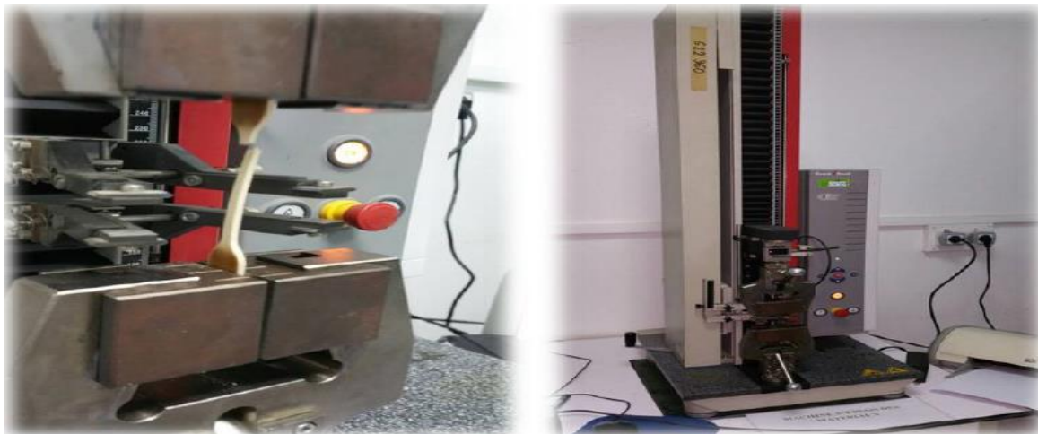
Figure 21 : Machine d'essai de traction de marque ZWICK de type BTC-FR 2.5TN.D09 (original 2019).
