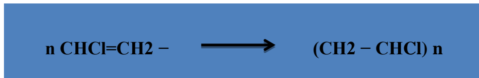
Figure 10 : Schéma de polymérisation du chlorure de vinyle [33].
