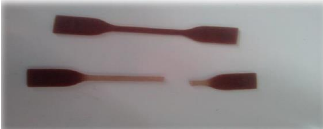
Figure 22 : Eprouvettes avant et après test d'attraction (original 2019).
