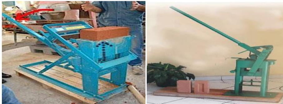
**Figure (13) :** Photos de Brique de terre crue comprimée réalisée à l'aide d'une presse manuelle.
