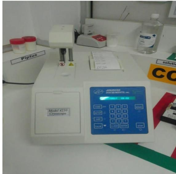
Figure n° 11 : photo d'un cryoscope prise a l'unité « DANONE »
