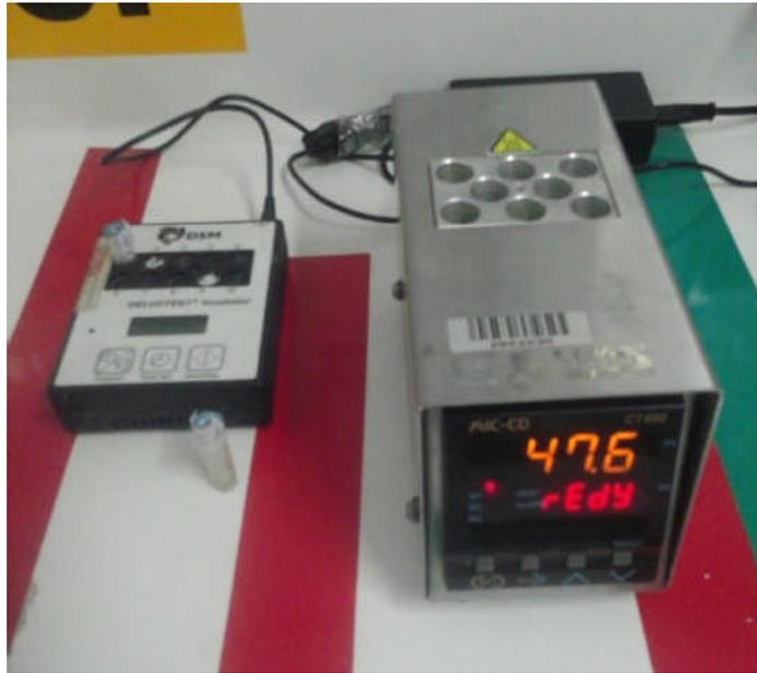
**Figure n° 10 : photo de l'appareil « BETA STAR COMBO » prise a l'unité de DANONE**
