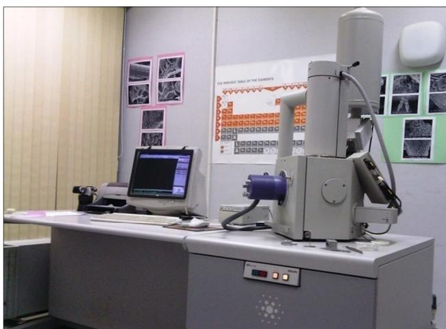
**Figure II.5 :** Photographie du microscope électronique à balayage utilisé.
