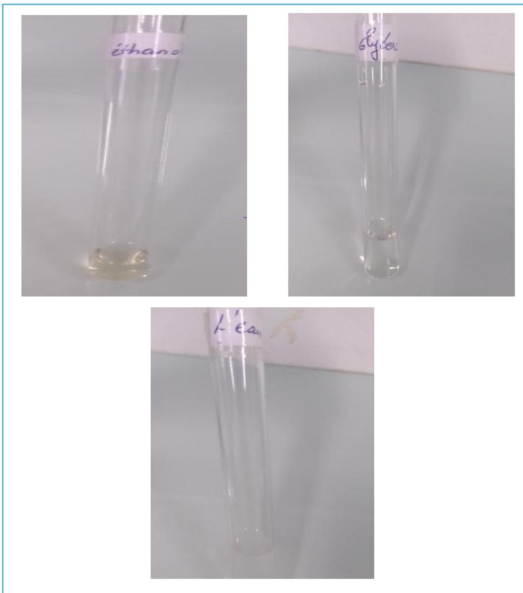
Figure 28 : Test de solubilité du produit synthétisé dans l'eau, éthanol et glycérol.
