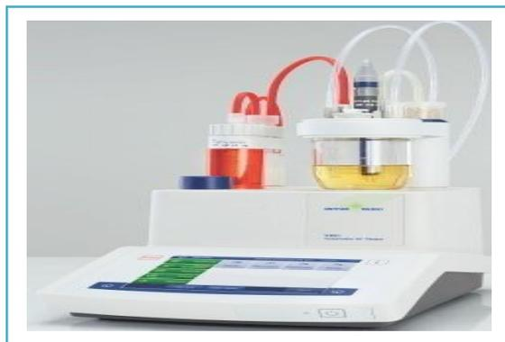
Figure 24 : Appareil de Karl Fisher Mettler Toledo
