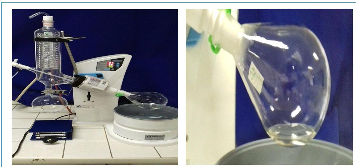
Figure 15 : Elimination de l'excès d'acétone par le Rotavapeur
