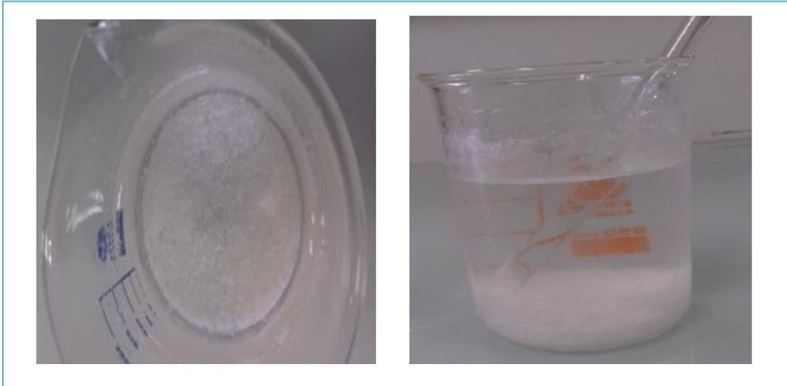
Figure 16 : Cristallisation du produit synthétisé dans l'eau glaciale.
