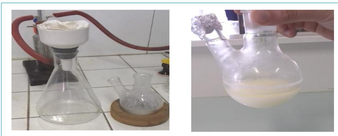
Figure 14 : Précipité d'hydroxyde de potassium, et la filtration sous-vide.
