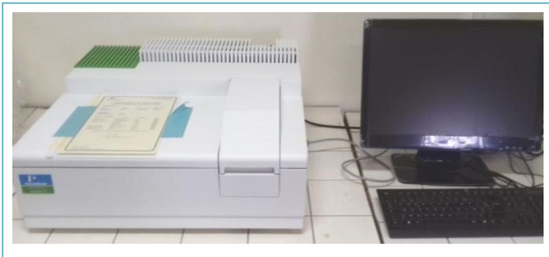
Figure 19 : Spectrophotomètre UV-VISIBLE à Balayage PerkinElmer Lambda 25.
