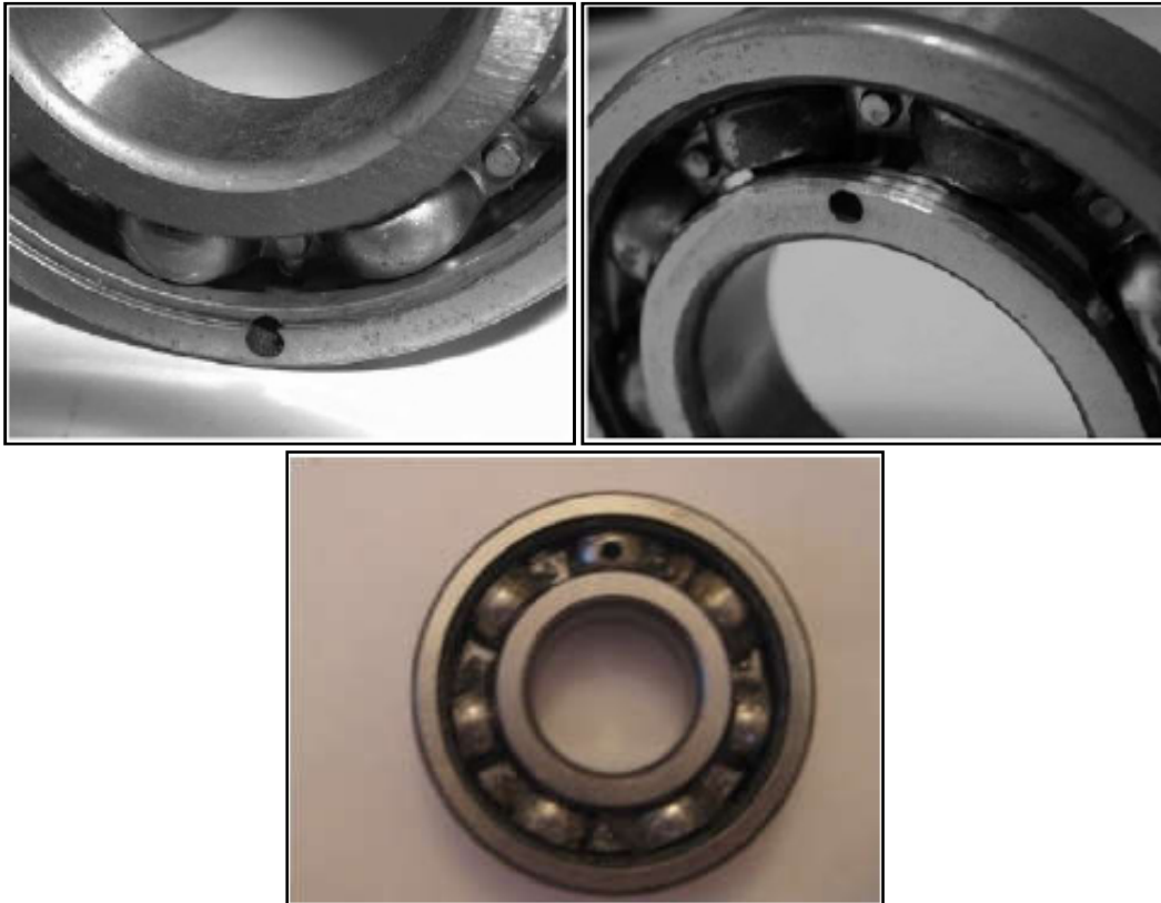
Figure I -16 : Les différents défauts dans un roulement [9]
