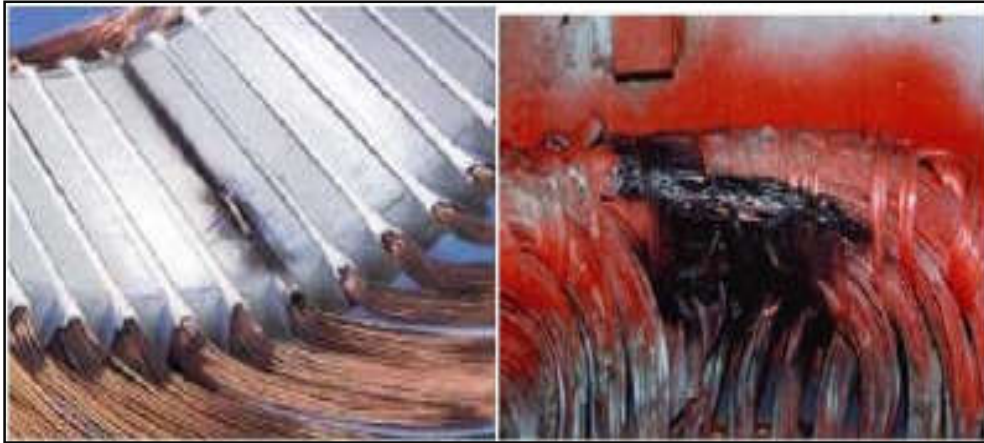
Figure I-10 : Exemples des dégâts dus au défaut de court-circuit statorique
