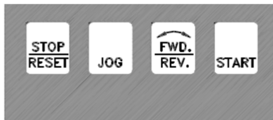
Figure II.7 : Les touches de commande en mode local.
