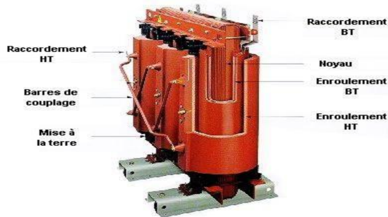
Figure 2-1 : Enroulements d'un transformateur.
