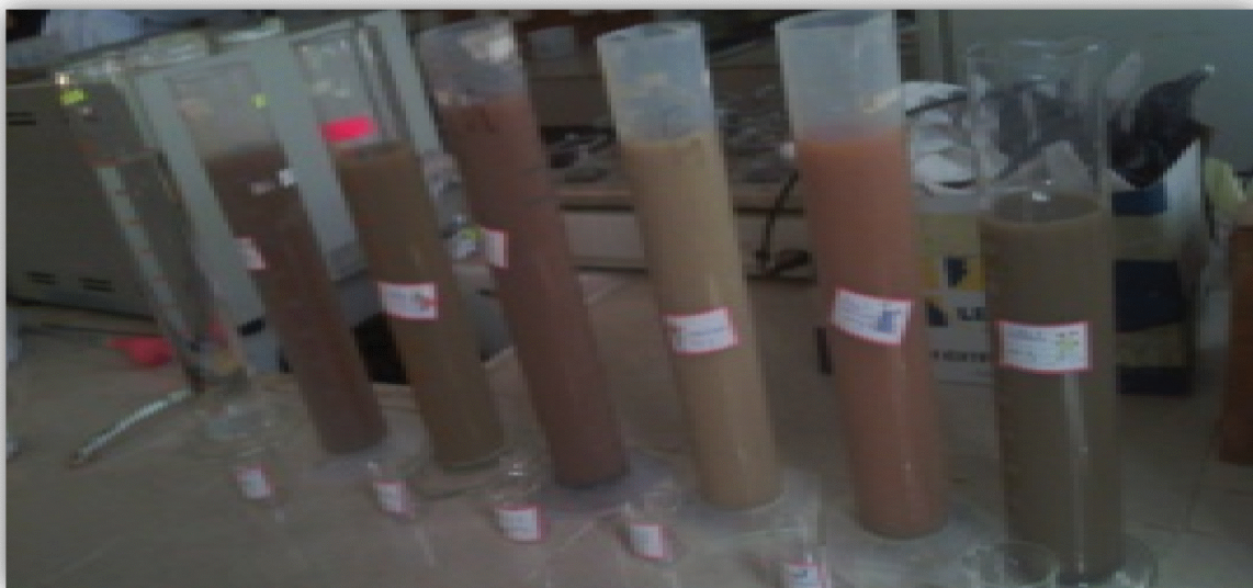
Figure 5 : détermination de la texture de différents sols (Photos originale, 2018)
