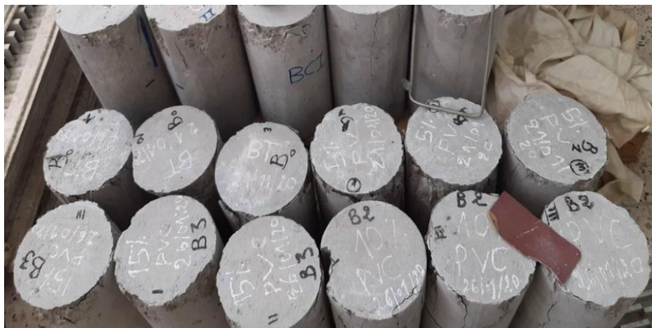
Figure IV.7 : L'état des éprouvettes après écrasement.
