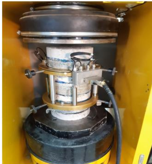
Figure IV.12 : Essai de compression avec les comparateurs LVDT sur une éprouvette confinée.
