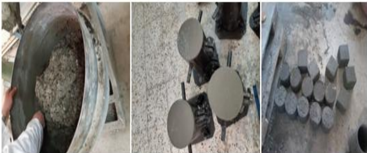
Figure IV.4 : Confection, moulage et démoulage des éprouvettes.
