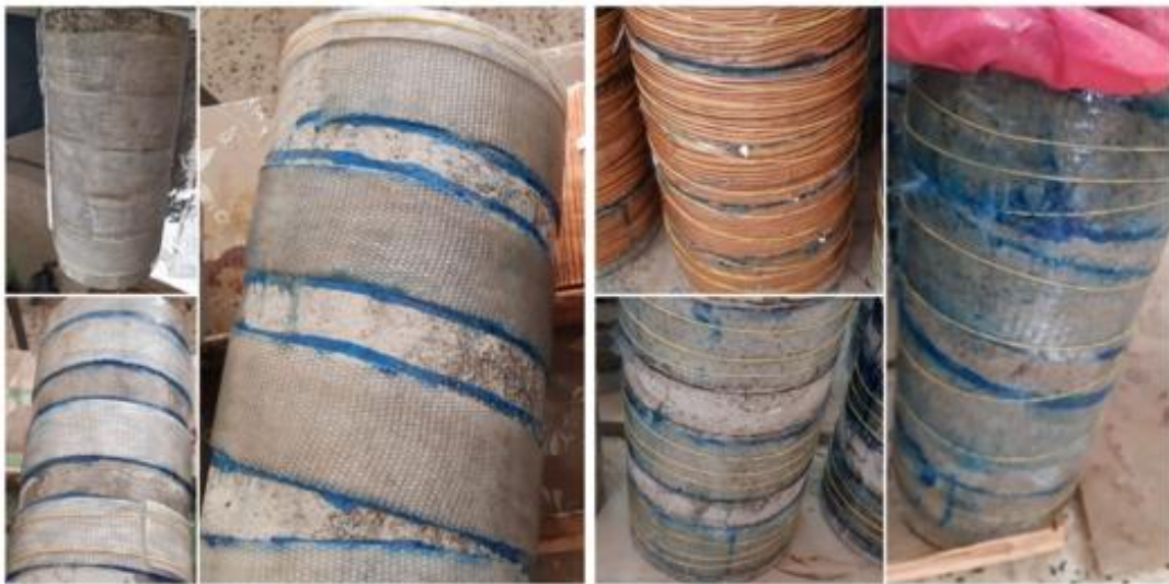
Figure IV.10 : Eprouvettes confinées avec tissu recyclé (à gauche) et fibres de verre (à droite).
