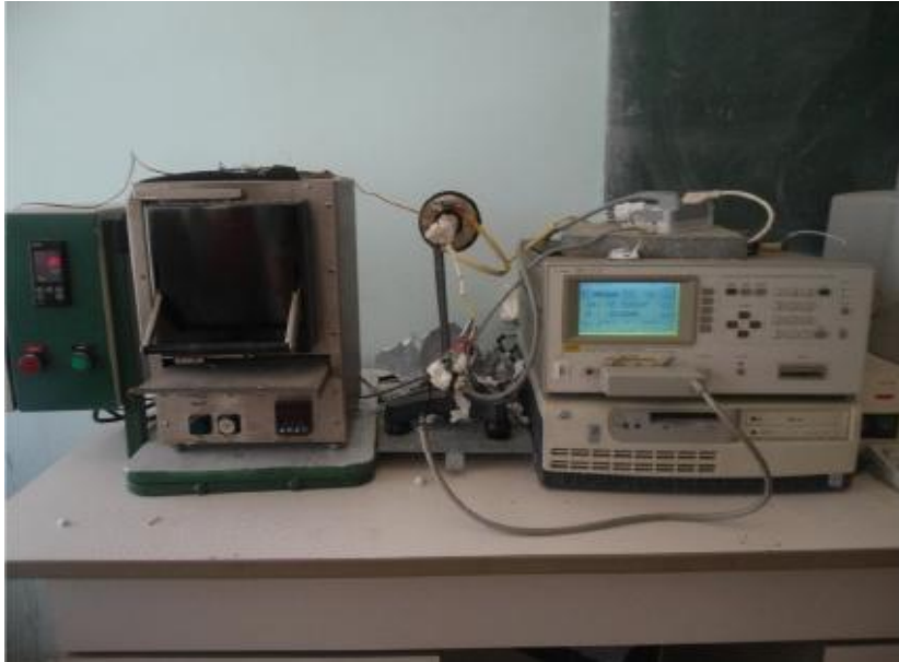
Figure. II.8 : l'appareil de mesures des propriétés diélectriques (Impédance mètre)
