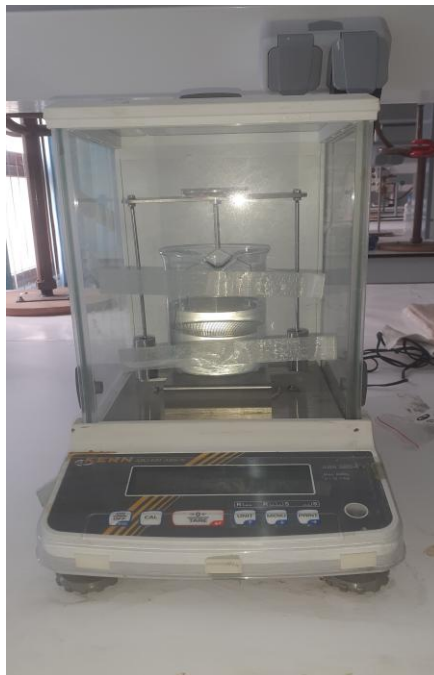
Figure. II.7 : mesure expérimentale de la densité par la méthode de l'Archimède
