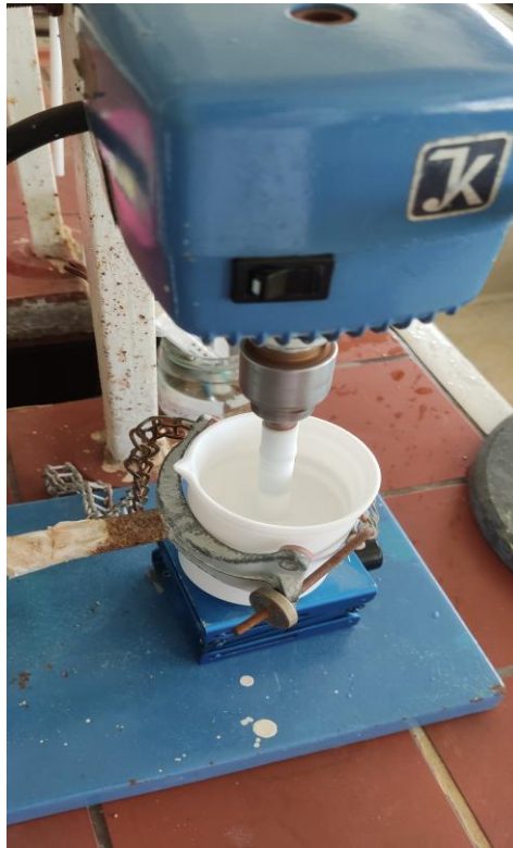
Figure II.1 : mélange des poudres dans un attriteur
