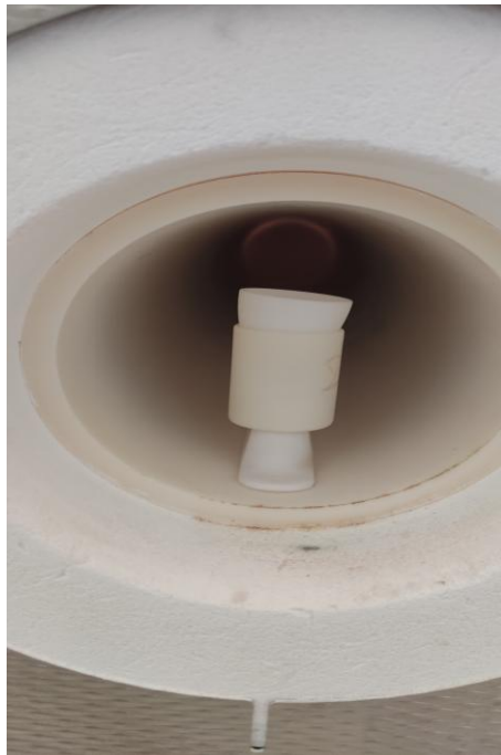
Figure .II.4 : frittage des échantillons a 1450 C°
