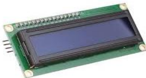
Figure II.12 : Écran et afficheur à cristaux liquides LCD I2C [34].
