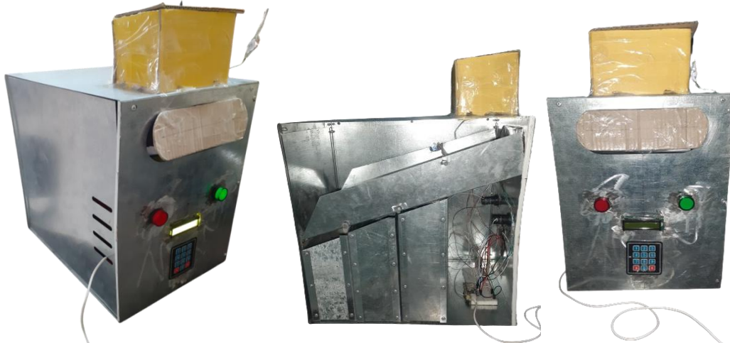
Figure IV.9 : Corbeille intelligente associe de tous les capteurs et actionneurs plus la partie contrôle.
