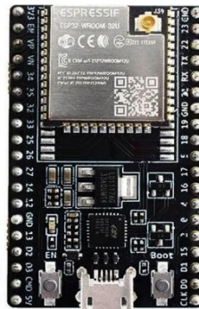
Figure II.8 : Micro contrôleur ESP 32 de type Dev Module [30].
