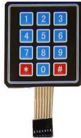
Figure II.11 : Clavier de dimension 4x3 pour introduire les consignes [33].
