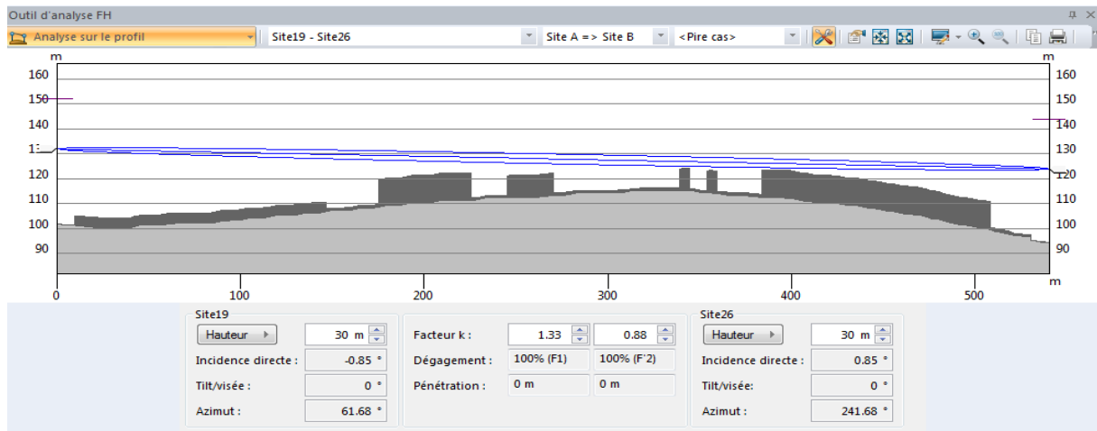
Figure 44 : Vérification de Dégagement de la zone de Fresnel après l'augmentation de la fréquence.
