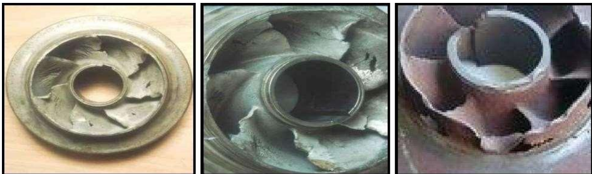
Figure V. 8. L'effet de cavitation sur les aubes
