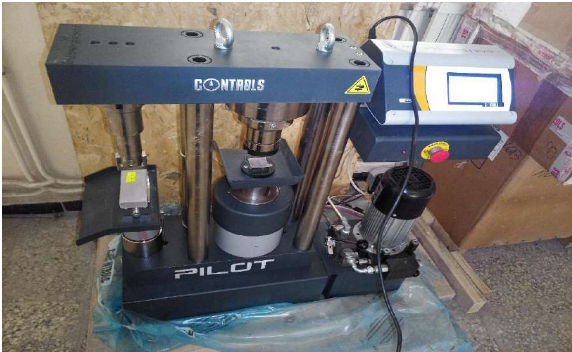
Figure II.21. Dispositif de résistances mécaniques de marque Controls de type PILOT PRO.
