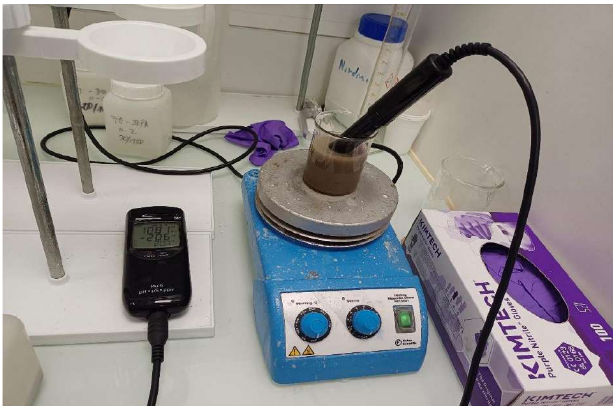
Figure II.13. Mesure de pH à l'aide d'un pH-mètre HANNA instrument.
