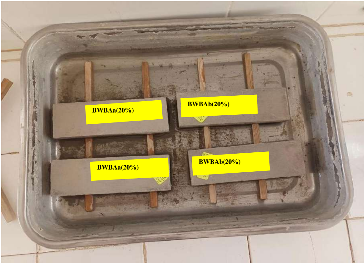
Figure II.23. Essai d'absorption d'eau capillaire.
