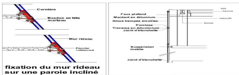
Fig.243. Détail des murs rideaux dans la tour
