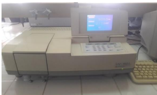
Figure IV.8 : Spectrophotomètre UV visible
