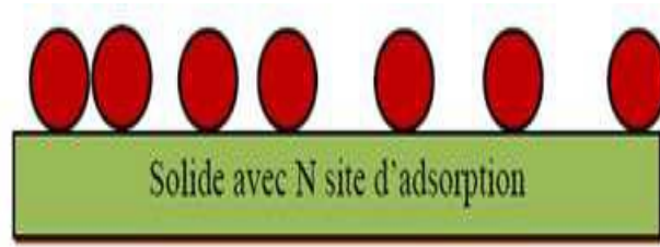
Figure III.3: modèle de l'isotherme de Langmuir en monocouche
