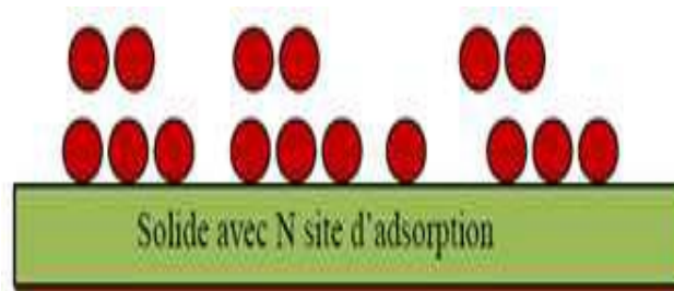
Figure III.4 : modèle d'adsorption de Freundlich en multicouches.
