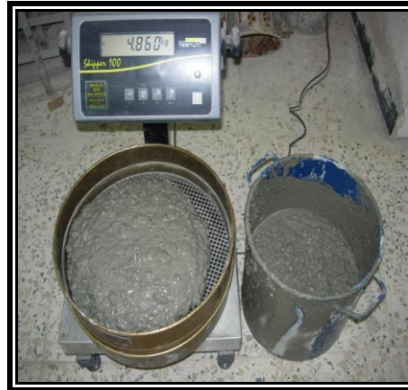
Figure V- 3: Photo descriptive de l'essai de stabilité au tamis (le tamis est de 5 mm).
