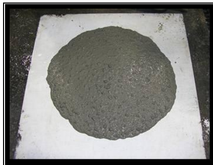
Figure I- 5: Test d'étalement d'un BAP.
