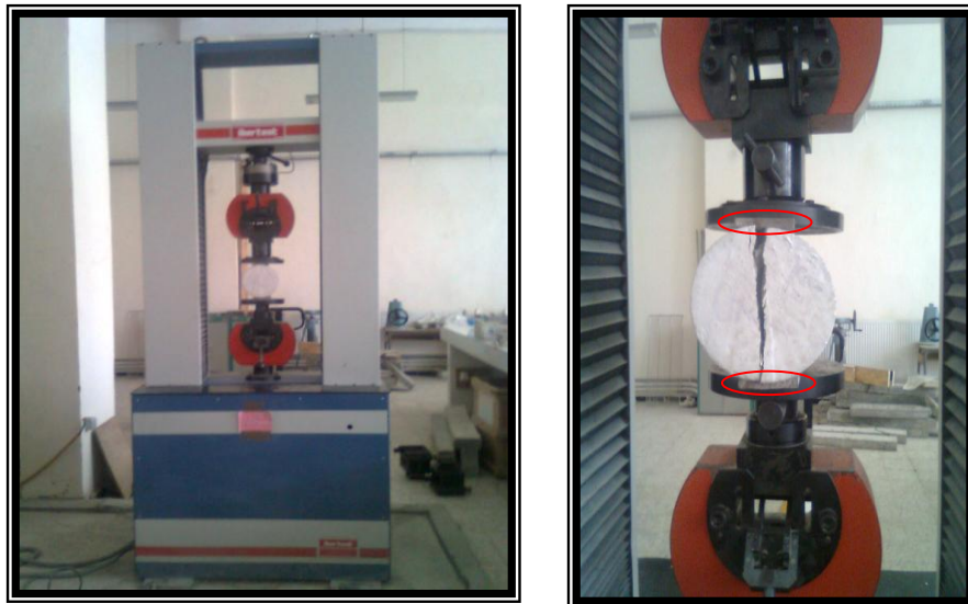
Figure V- 6 : Dispositif de chargement pour l'essai de fendage, rupture de l'éprouvette.
