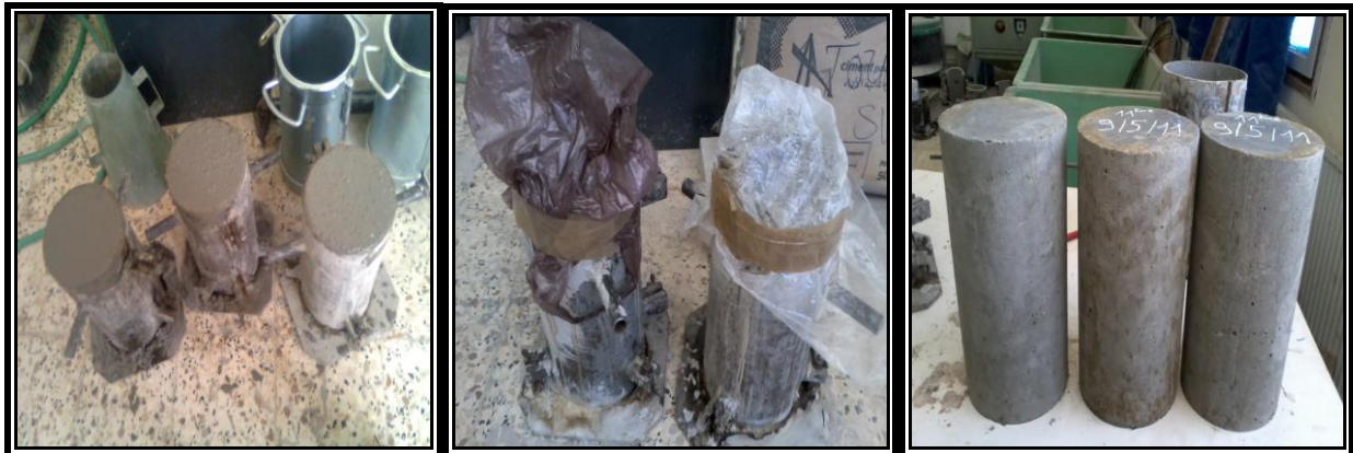
Figure V- 4: Remplissage des éprouvettes, protection des éprouvettes d'un film plastique ; apparence des éprouvettes après le décoffrage, marquage des éprouvettes.
