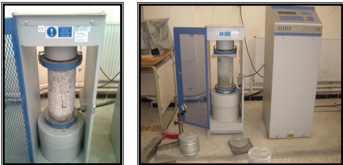
Figure V- 5 : Rupture de l'éprouvette ; La presse utilisée.
